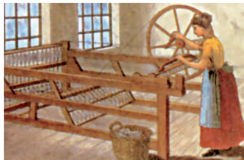
Првата машина за предење, 1764 г.
