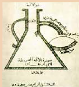
Siqib chiqarilgan suvning aniq hajmini aniqlash idishi XI asr. Beruniy
