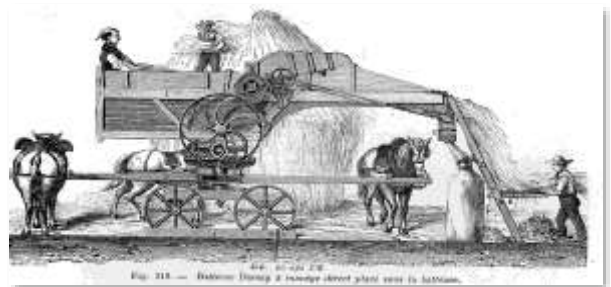
D. Batoză (treierătoare), utilaj care desface boabele de pe spice sau știuleți (sec. al XIX-lea)
