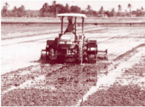
Gambar 9.2 Traktor sebagai pengganti kerbau untuk membajak sawah
