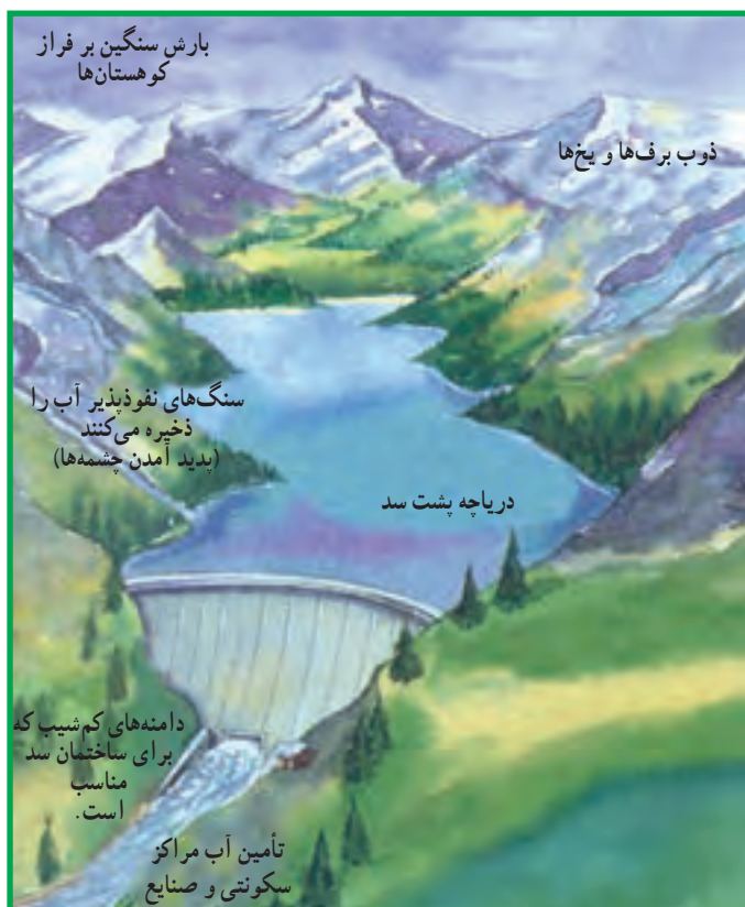
شکل ۳- مهار آب‌ها برای تولید برق در کوهستان
