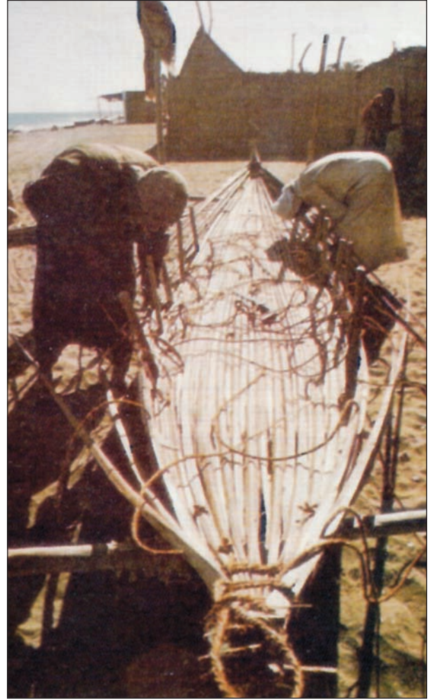
(١) صناعة المراكب في سلطنة عُمان بواسطة سعف النخيل. وهي من الحرف التقليدية في دول الخليج العربية
