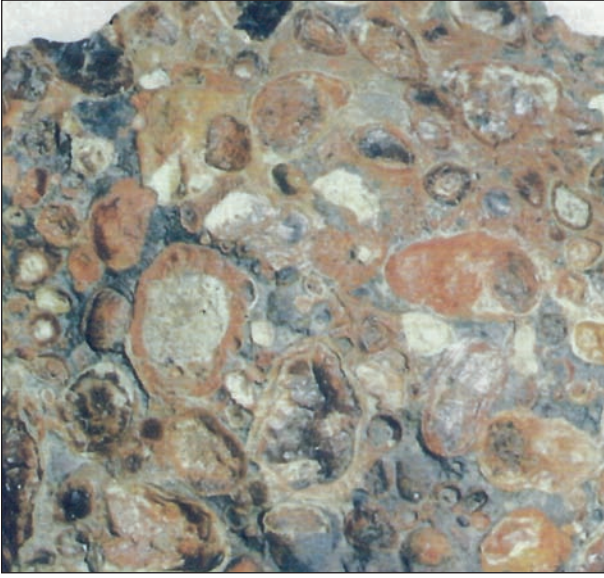
(٤) خامات البوكسيت في منطقة الزبيدة في السعودية وهو المادة الأولية لصناعة الألومنيوم
