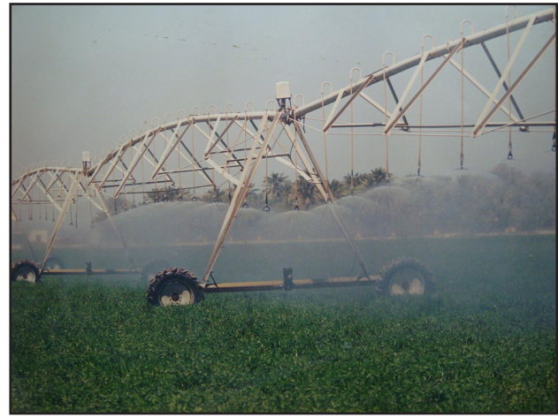
مستند ٣) الري بالرش المحوري (إحدى طرق الري الحديثة)
