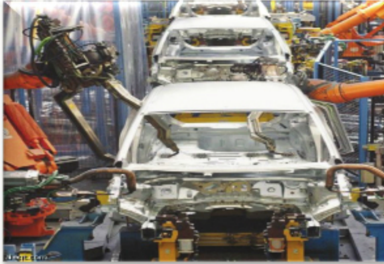
الصورة (١٨) استخدام الروبوت في صناعة السيارات
