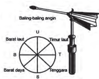
Gambar 9.6 Alat penunjuk arah angin Sumber: www.e-dukasi.net
