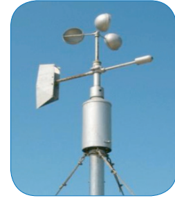
جهاز الأنيمومتر وجهاز دوارة الرياح
