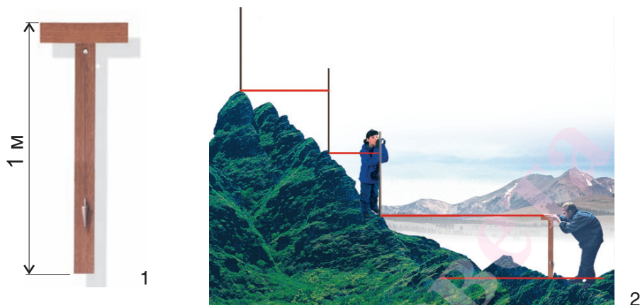
Мал. 28. Самаробны нівелір (1); вызначэнне адноснай вышыні ўзгорка (2). Як вызначаецца адносная вышыня ўзгорка?
