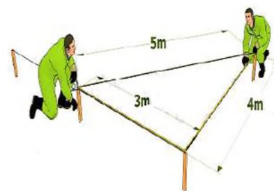
Técnica de escuadrando terrenos, con el triángulo mágico.
