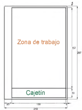
Partes de una hoja para el dibujo
