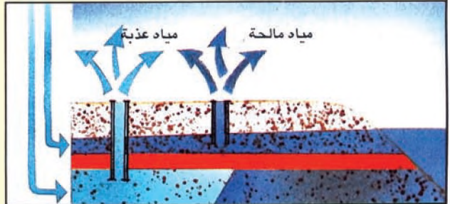
عند وصول المياه المالحة إلى البئر يصبح من الضروري تعميها أو حفر بئر جديدة للوصول إلى الطبقة الخازنة السفلية.
